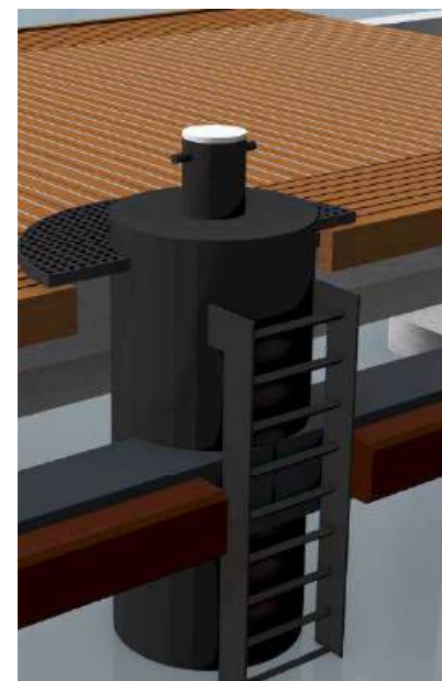
Drenkelingentrap op afmeerpaal
