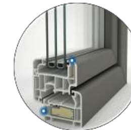
trippelglas kozijnen achtergevel Kunststof kozijnen, volledige pui op balkon (geen borstwering) Ug=0,7& Uf=1,5 (eis NEF en RVO)
