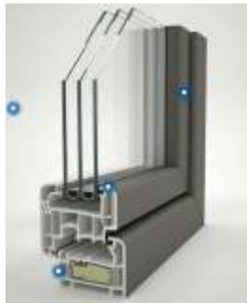
Driedubbel glas U-waarde = 0,7; kozijn minimaal U = 1,5
